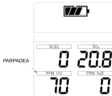
Figura 3-8. Instrumento en alarma de gas tóxico
